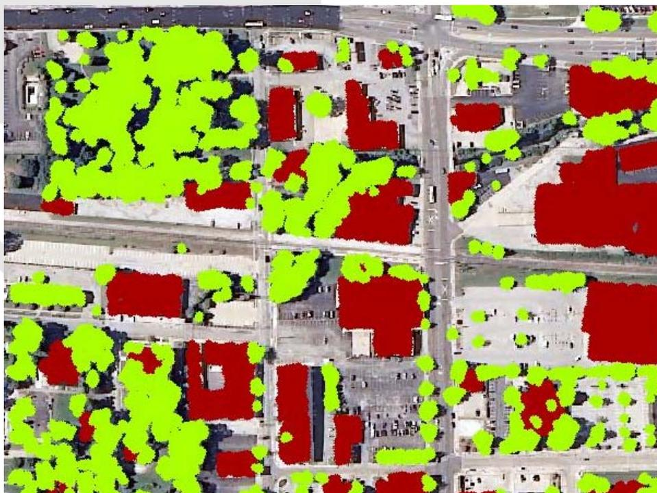
*Distinção entre objetos edificação (vermelho) e vegetação (verde) em ambiente urbano usando recursos de classificação de imagem IR e modelo de elevação derivado do Perfilamento a LASER*
