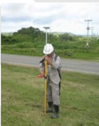
Levantamento RTK com link de rádio UHF/VHF
