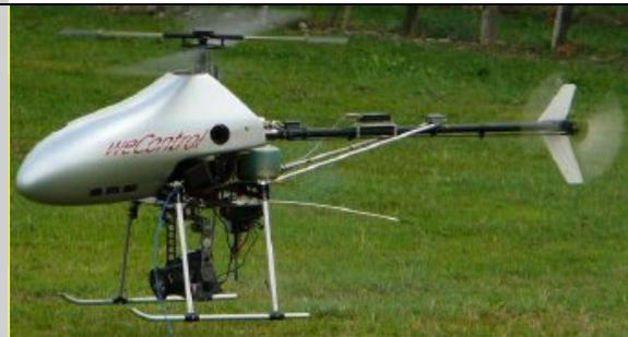
Mini UAV – Equipado com câmara RGB
